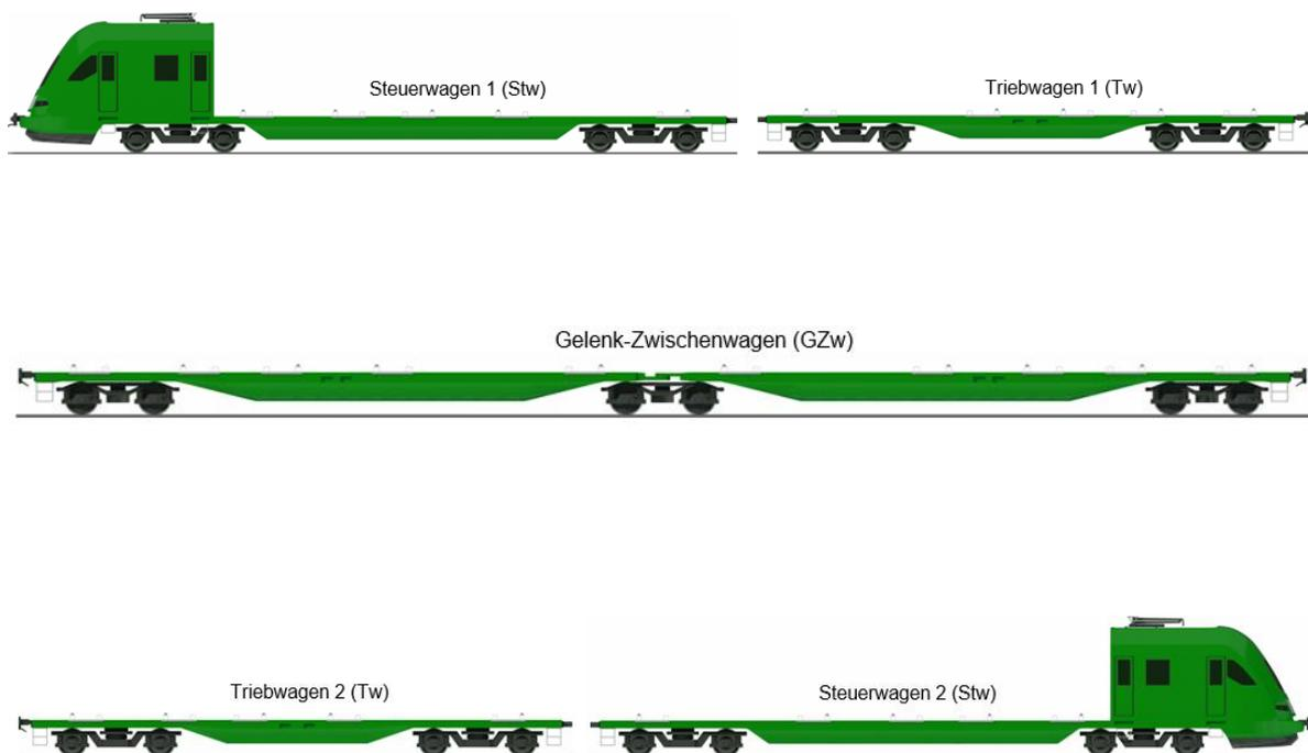
Mit dem modularen Aufbau können die Anzahl der Triebwagen und Gelenk-Zwischenwagen je nach Bedarf gewählt werden.
